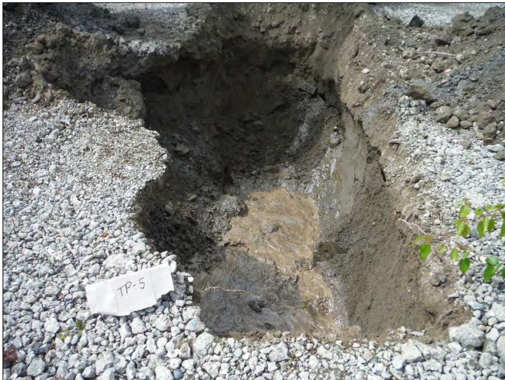
14. Test pit TP-5.
